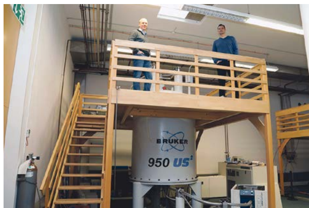
Große Geräte für die Forschung an kleinsten Molekülen: Dr. Martin Hengesbach (links) und Dr. Andreas Schlundt haben mithilfe eines Kernspinresonanz-Spektrometers an der Goethe-Universität unter anderem Proteinstrukturen von SARS-CoV-2-Proteinen bestimmt. Foto: Dettmar
