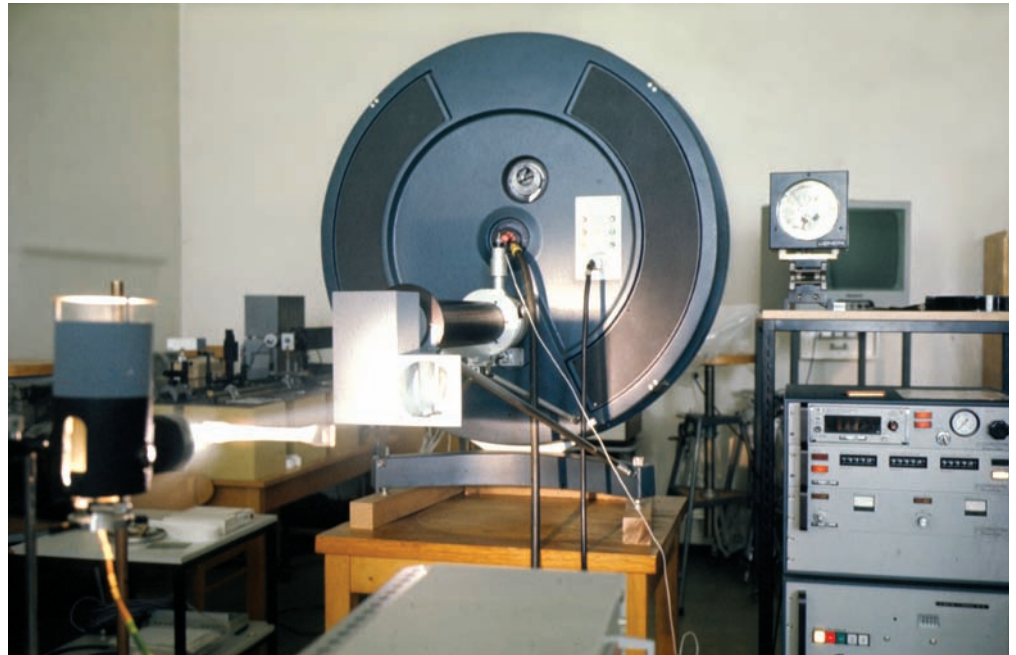
Die legendäre Drehspiegelkamera, mit der Aufnahme Frequenzen im Bereich von Millionen Bildern pro Sekunde auf 35-mm-Film möglich waren – eine schier unglaubliche Zeitdehnung.
