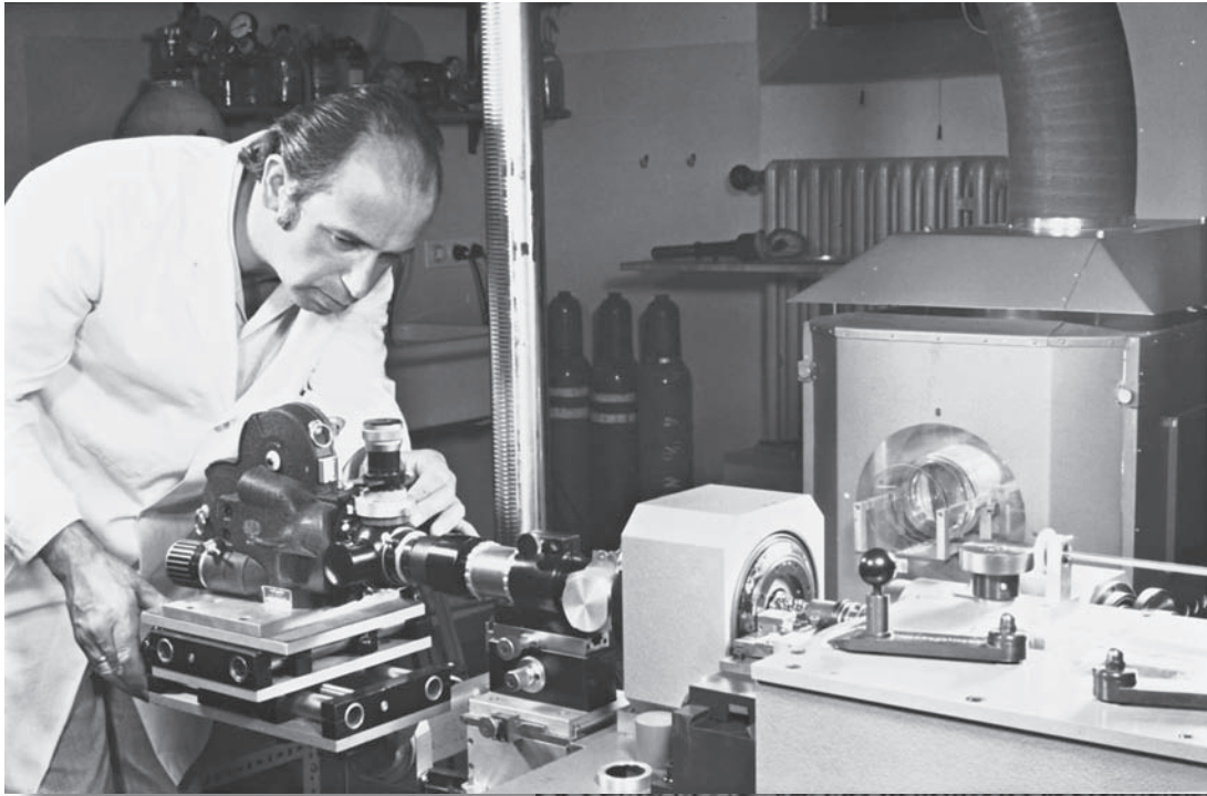
Oben: Joseph Thienel richtet den „Zerspanversuchsstand“ für einen nächsten Take ein. Ein Mikroskop zwischen Kamera und Drehbank gewährt den Einblick in das bislang unerforschte Geschehen im Feingefüge der Metallproben.
