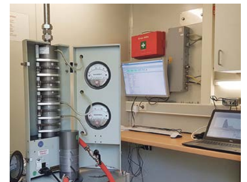
Mit dem Kaskadenimpaktor lassen sich Partikel unterschiedlicher Größe getrennt sammeln.
