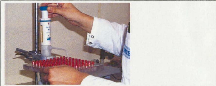
Abb. 3: Befüllen der Hartgelatinekapselfn mit geschmolzener halbflüssiger Zubereitung mittels Dispenser.
