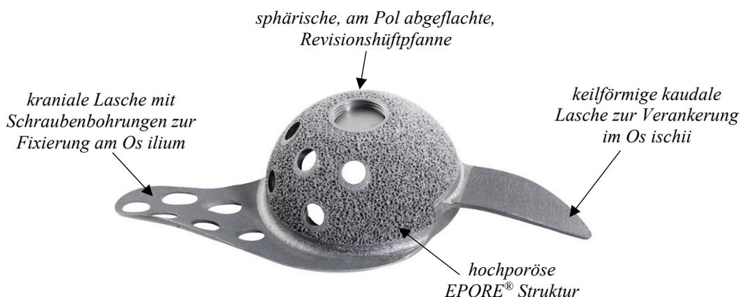
Abb. 14: MUTARS<sup>®</sup> RS Cup (Quelle: Part of the Technical Documentation – Clinical Evaluation – MUTARS<sup>®</sup> RS Cup-System, Firma implantcast GmbH)
