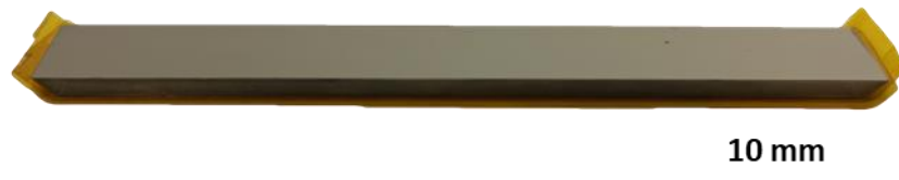
Abbildung 60: Um zu verhindern, dass die Rückseite des Kristalls beim Aufdampf-Prozess beschädigt wird sowie die abgeschrägten Kanten, die für den IR-Strahl durchlässig sein müssen, mit Gold beschichtet werden, wurden diese Bereiche mit einem Polyimid-Klebeband (gelb) geschützt.
