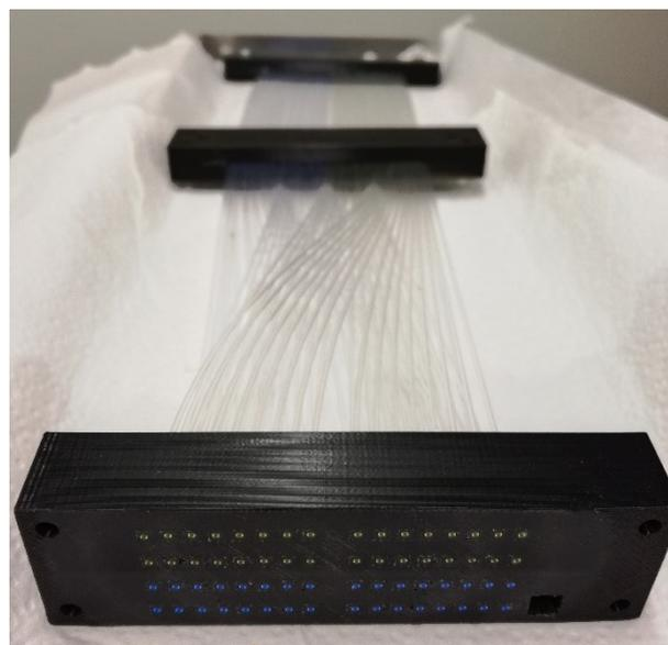
Abbildung 3.1.6: Fasermatte (hinten) und Faserblock zum Anschluss auf das SiPM-PCB (vorn).
