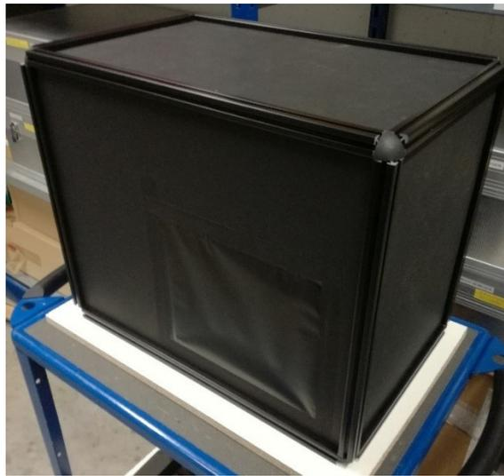
Abbildung 3.1.3: Blackout-Box aus eloxierten Item-Profilen, Black Posterboard, schwarzem Capton und Black Masking Tape, die für normales Raumlicht lichtdicht ist.
