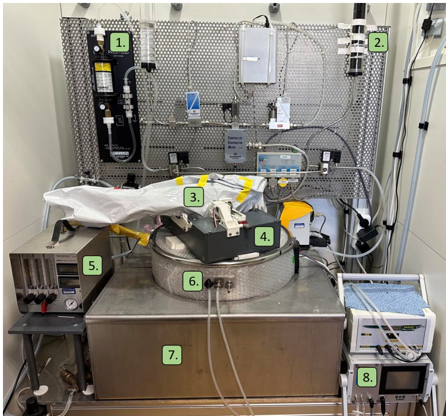
Abbildung 3.1. Expositionssystem Radonkammer; 1. Radium-Quelle, 2. Aktivkohlefilter, 3. Beatmungsbeutel in radondichtem Beutel, 4. Beatmungsgerät, 5. Aerosolgenerator, 6. Edelstahlfass, 7. Wasserbad, 8. Messgerät zur Bestimmung der Radonaktivitätskonzentration und der Zerfallsprodukte
