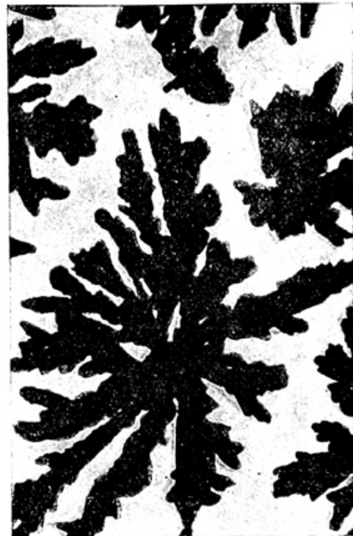
Fig. 11. Vergifteter Kristall von Mekonsäure, durch Anilin violett dunkel gefärbt, in knorrige Strahlen ausgewachsen.
