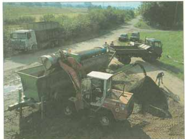
Abb. 38: Stationäres Trommelsieb (hier Wawik) im Einsatz bei der Deponie Berghaupten
