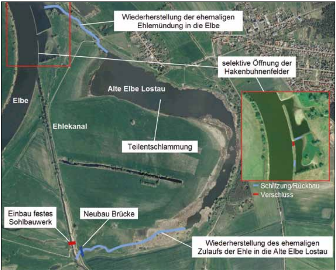
Abb. 9: Vorgesehene Kernmaßnahmen des Projektes „Renaturierung Alte Elbe Lostau“. Quelle: Luftbild Cardo-GIS des LHW.
