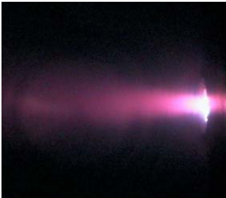
Abbildung 28: Foto einer MSE unterstützten Entladung mit Gasfluss bei der Expansion ins Vakuum (Seitenansicht).
